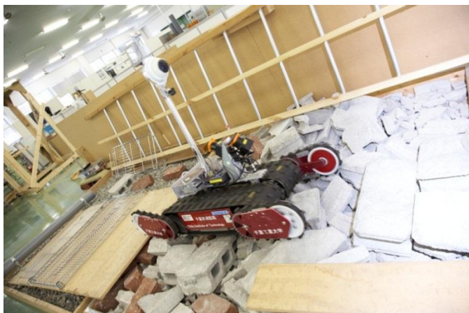
Abbildung 3: Die optimale Stellung der Flipper für die Überquerung unterschiedliche Oberflächen, wie beispielsweise Geröll, ermittelt der Roboter selbst. © 2012 fuRO
