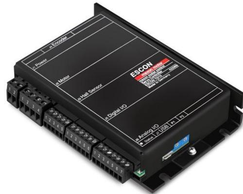
*ESCON 70/10: Digitaler Servokontroller für bürstenbehaftete DC-Motoren und BLDC-Motoren (bürstenlose DC-Motoren) mit Hall-Sensoren bis ca. 700 Watt, © 2013 maxon motor*
