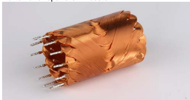
Abbildung 5: Herzstück des maxon-Motors ist die eisenlose Wicklung, System maxon. Dieses Motorprinzip hat seine ganz besonderen Vorteile. Das magnetische Rastmoment fehlt völlig und die elektromagnetischen Störungen sind vernachlässigbar gering. Der Wirkungsgrad übertrifft mit bis zu 90% andere Motorsysteme bei weitem.
